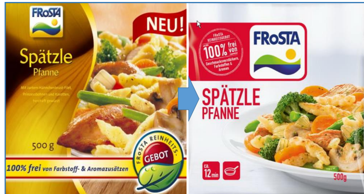
Abb. 3 Aufhellung der FROSTA-Verpackung zwecks Verbesserung der Regranulat-Qualität (rechts: neue Bedruckung)
